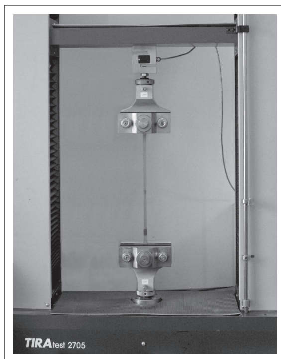
Rysunek 5.10. Zrywarka TIRA test 2705 z zamocowaną próbką kompozytu magnetoreologicznego typu ASC – Ed podczas eksperymentu.
